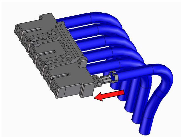
・性能信頼性を維持するため、圧着端子を斜めに挿入しないで下さい。
