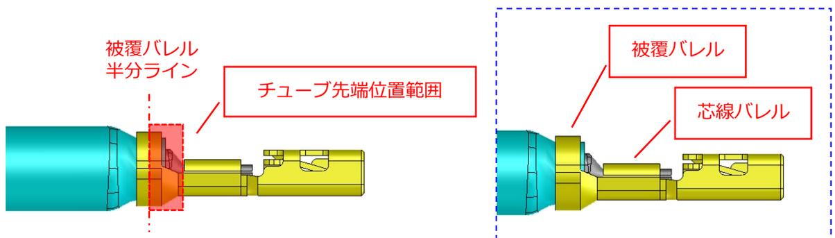
④ ④チューブに熱をかけて収縮させる (完成)
