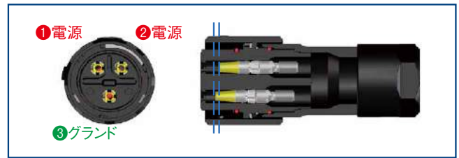
GNDが先に接触する構造 (3芯)
