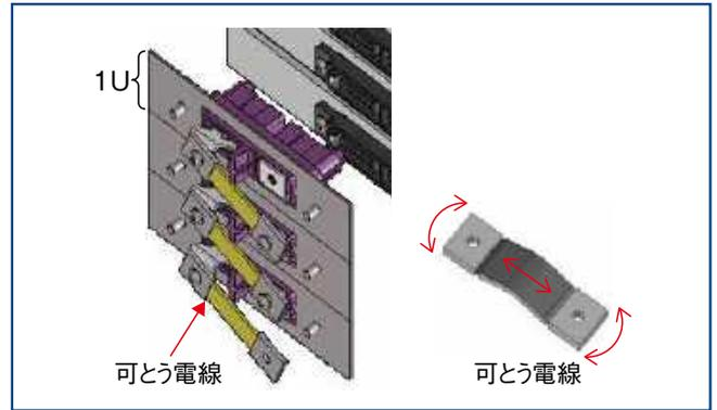
3. レセプタクルのフローティング構造
