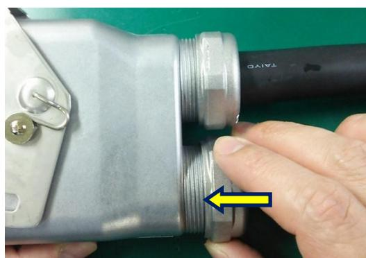
エンドベルキャップを大口径スパナ（開き幅 45mm 以上）にて締め込む。
