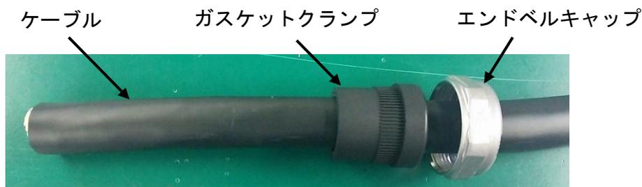
【ポイント】 キャブタイヤケーブルの端面から 100mm の位置にマジック等でマーキングを行う。（※ガスケットクランプ締め付けの位置決めの目印として行います。）
