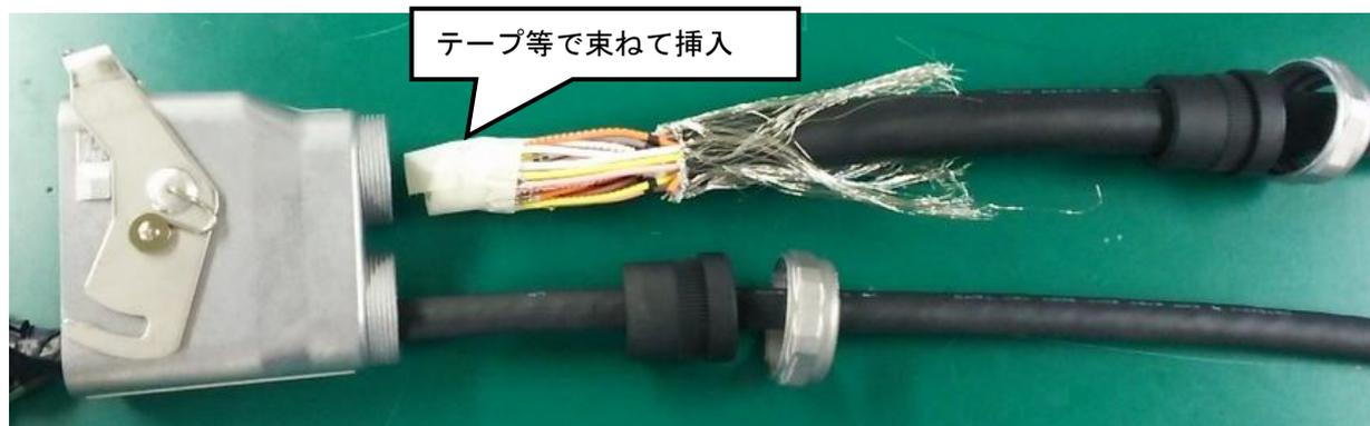
圧着した端子の束を掴み、カバーケースの給電側ケーブル口（上側を給電とした場合、写真の通り）に通す。
