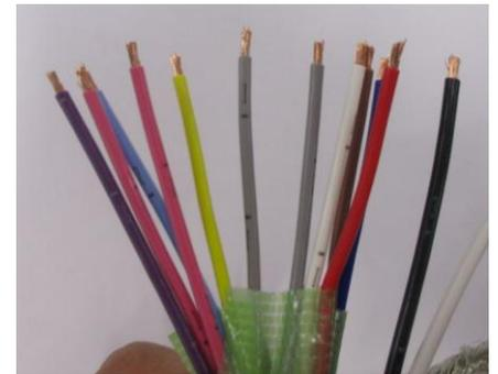
行ごとに予め電線を引き回した後に電線をカットし、長さを揃える。
