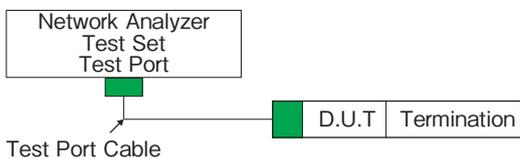
(注 1) ケーブル用コネクタは適合ケーブル 10cm の両端にコネクタを取り付けた状態で測定します。
