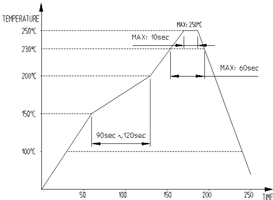
[Fig1]. 推奨リフロープロファイル
