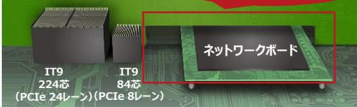
長手寸法の短縮により、オプションボード下に他部品を搭載可能
