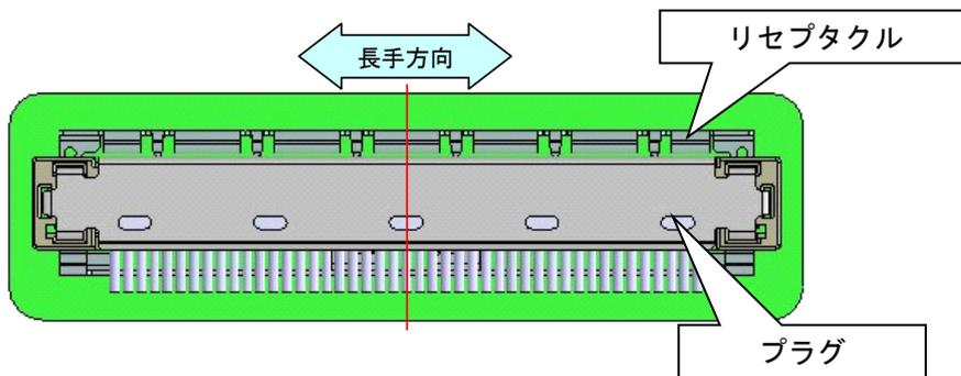
3-1-2: プラグコネクタをカン合方向に軽く押しながら前後左右のガタを確認し、レセプタクルの中央に位置されている事を確認して下さい。
