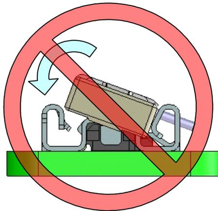
3-1-5 : プラグコネクタが確実にカン合されていることを確認ください。片側が浮いていたり、斜めにカン合されている場合は、一度カン合を外し再度カン合し直して下さい。
