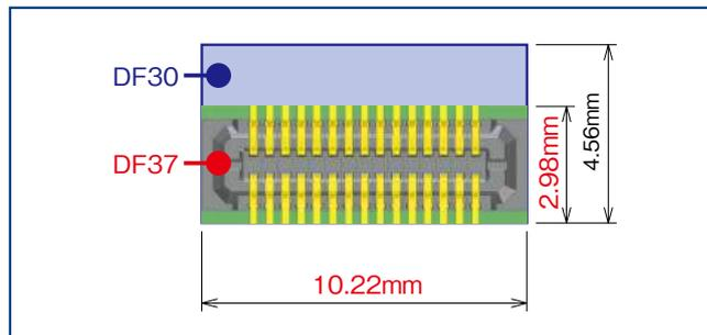
基板占有面積の比（40極、0.4mmピッチ、0.98mm/1.5mm高さ）
