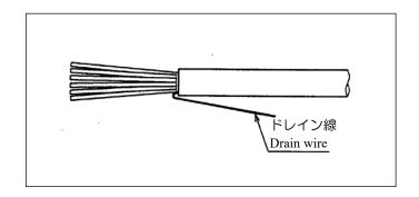
④ ツイストペアーのよりを、ケーブルシース端面までほぐし、しごいてクセを矯正します。この時、ドレイン線はケーブル外側に曲げておいてください。
