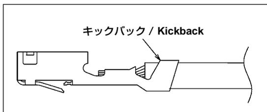
工具に適合しない電線を使用した時に、発生することがあります。キックバックが著しいと、ハウジングに挿入した後ハウジングから端子が露出し、耐圧上の問題となることがあります。
