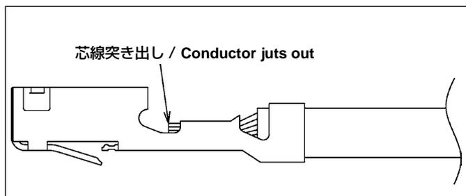
適正なストリップ長さ：圧着した際、ワイヤーバレル先端から芯線が突き出しており、また被覆がインシュレーションバレルより引っ込んでいたりシールドバレル内に入り込んでいない状態であること。
