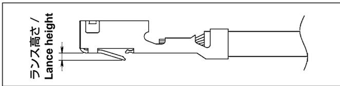
圧着した端子のランスの高さが、所定の寸法内にあるか確認してください。
