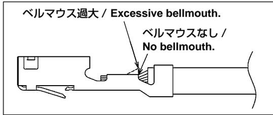
工具の調整状態や、工具への端子のセットの仕方により、発生することがあります。ベルマウスがなかったり大き過ぎることにより、芯線の断線や引っ張り強度の不足、電気的接続の不安定となる恐れがあります。
