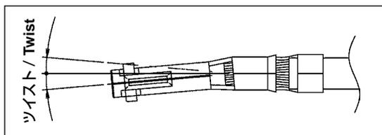
工具の調整状態や、工具への端子のセット状態、端子の取り扱いにより、発生することがあります。ツイストが著しいと、ハウジングへの挿入が行えないことがあります。
