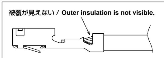
電線のストリップ寸法が不適切な時や、工具への電線のセットの仕方により発生することがあります。
