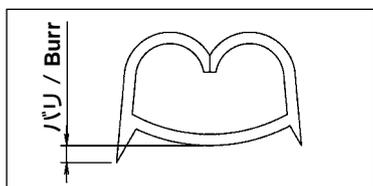
工具の調整状態やクリンパ・アンビルの摩耗・傷がある時、発生することがあります。バリが著しかったり著しく左右が不均一なことにより、バリ部での端子の亀裂や電気的接続の不安定、強度不足、端子の変形となる恐れがあります。
