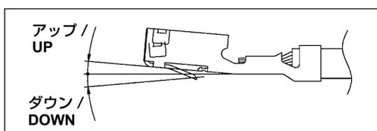
工具の調整状態や摩耗、端子の工具へのセット状態、端子の取り扱いにより、発生することがあります。ベントアップ・ダウンが著しいと、ハウジングへの挿入が行えないことがあります。
