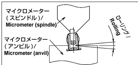
工具の調整状態や歯型の摩耗、工具への端子のセット状態、端子の取り扱いにより、発生することがあります。ローリングが著しいと、ハウジングへの挿入が行えないことがあります。
