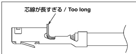
電線のストリップ寸法が不適切な時や、工具への電線のセットの仕方により発生することがあります。
