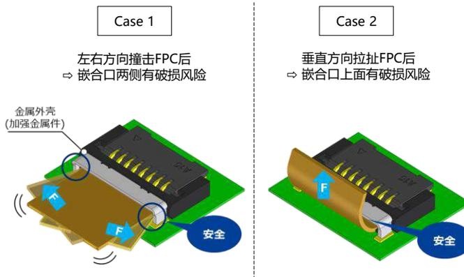
通过金属外壳(加强金属件), 提高破损强度
