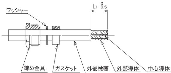
②ケーブルの先端よりクランプを挿入し、ケーブルの外部導体をクランプに折り返す。この際余った外部導体をナイフ等で切り落とす。
