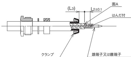
⑤シェルにケーブルおよび各部品を挿入し締め金具を十分に締めつける。(2~3N・m)
