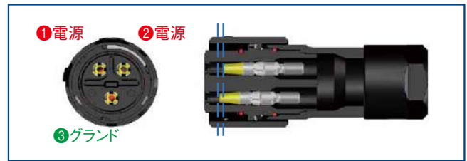
GNDが先に接触する構造 (3芯)
