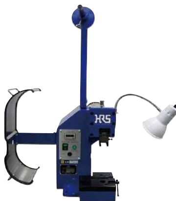
自動圧着機 圧着機本体 CM-105C
