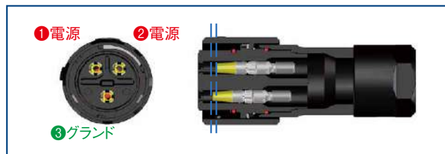
GNDが先に接触する構造 (3芯)
