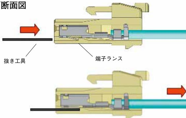
1. 図のようにかん合部をのぞいて抜き治具を押し、端子ランスを上へ上げます。
