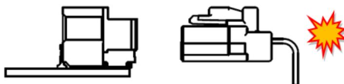
ケーブルの最小曲げ半径(R)は、ケーブル仕様を確認の上、ご使用下さい。
