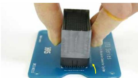
4) インターポーザーを取り外したら、固定側レセプタクルに新しいインターポーザーを取り付けることができます。
