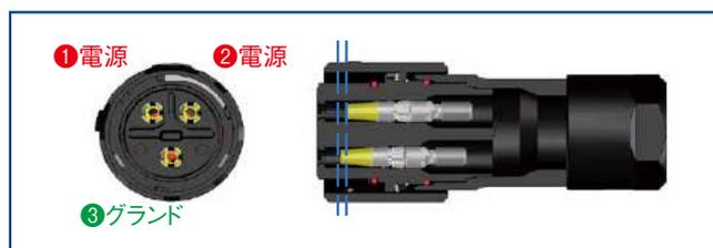
GNDが先に接触する構造 (3芯)
