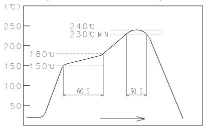
FIG – 2 RECOMMENDED REFLOW PROFILE TEMPERATURE
