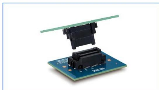
FX26 シリーズはパワートレイン内部接続向けでも安心して使って頂ける品質を達成しており、従来のケーブルコネクタ置き換えによる組立性の向上とトータルコストの低減をサポートします。さらに、端子間 1mm の狭ピッチを実現したことで、小型化も実現。アプリケーションの小型化を可能にし、セットの付加価値向上に寄与します。
