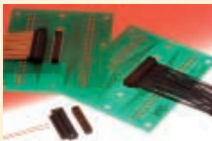
ノートPCのLCD接続などに適した0.9mmピッチで高さ3.8mmの基板対電線用コネクタです。
