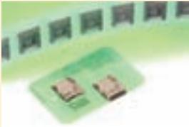
携帯電話やミュージックプレーヤーで使われる超小型メモリーカード（マイクロSDカード）用ソケットで、カードの飛び出し機構等、小型ながら操作性の良い構造となっています。
