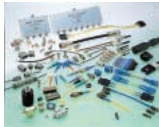
同軸コネクタは、マイクロ波のような高周波信号を接続する特殊な高性能コネクタであり、主にマイクロ波通信機、衛星通信装置、電子計測器、または携帯電話やPHSなどの移動体通信関連機器、伝送・交換装置などに使用されるコネクタであります。なお、光コネクタもこのなかに一括しております。
