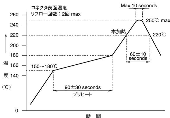
クリームはんだの種類、メーカー、基板サイズ、その他の実装部材等の条件により異なる場合がありますので、実装状態を十分ご確認の上ご使用願います。
