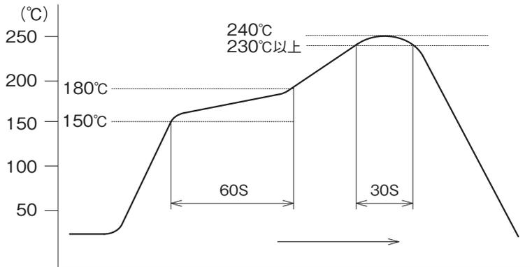
測定は基板表面としています。クリームはんだの種類、メーカー、基板サイズ、その他の実装部材等の条件により異なる場合がありますので、実装状態を十分ご確認の上ご使用願います。
