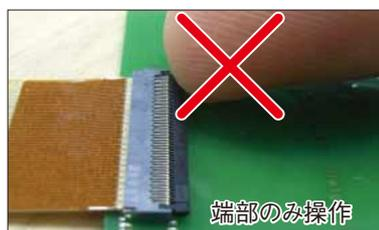
※本コネクタは、バックフリップタイプ構造を採用しており、FPC 挿入方向とアクチュエータが異なる方向にあります。
