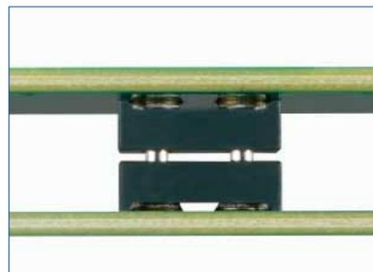
(注1) 銀の変色を防ぐため、端子に直接手で触れないでください。
