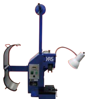
自動圧着機 圧着機本体CM-105C 901-0001-0
