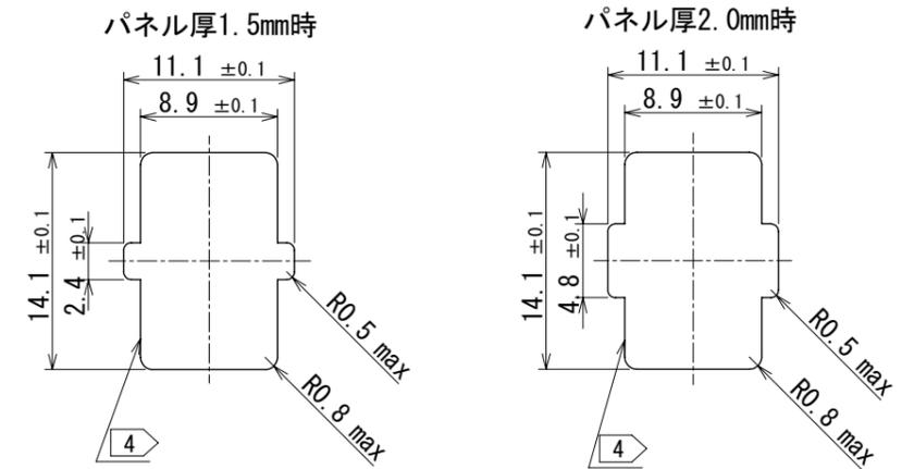
4 パネル組み込み時のカバーケース削れ防止として、外周（上記太線部）にC0.1をつけて下さい。パネルへの組み込み回数は10回までとなります。
