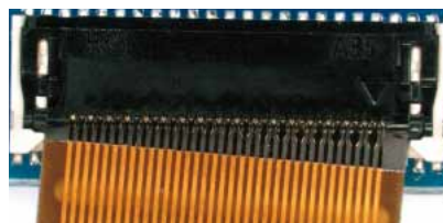
FPCが斜めに挿入されている
