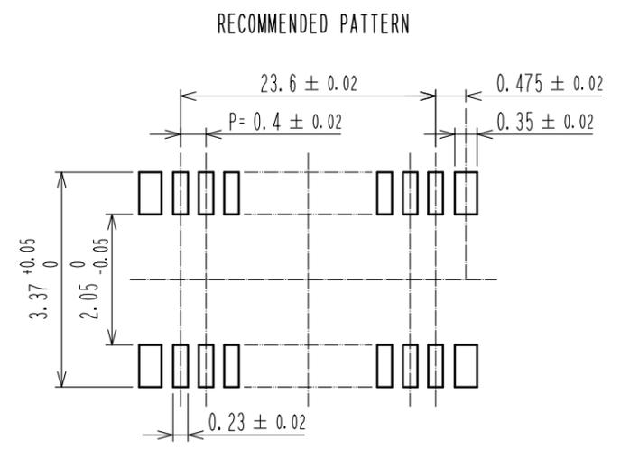
RECOMMENDED METAL MASK THICKNESS : 120 μm
